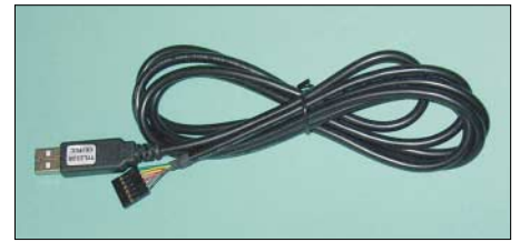
Bild 7: Bei diesem USB-Kabel ist im Stecker alles zur Umsetzung von USB auf RS232-TTL-Signale enthalten.
