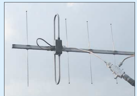
Bild 5: Zur Entkopplung wird das kurze Stück Koaxialkabel von der Antenne zum Richtkoppler etwa waagrecht weggeführt. Sein direkter Anschluss an die Antenne ist wünschenswert, aus Platzgründen jedoch nicht möglich. Fotos: Autor
