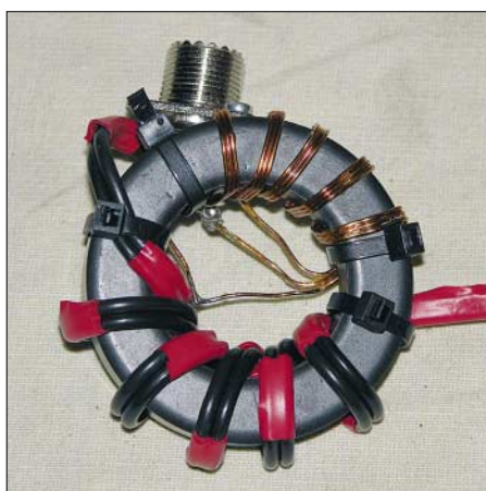
Bild 2: Praktische Ausführung des Baluns
