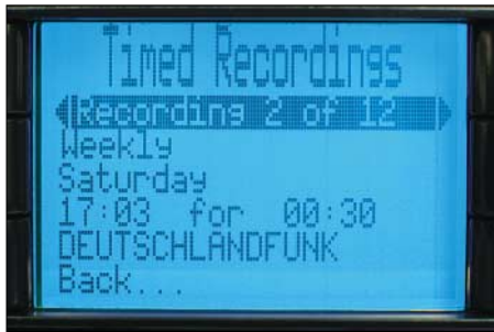
Bild 9: Bis zu zwölf Sendetermine lassen sich minutengenau programmieren, zu denen der Empfänger digitale Sendungen automatisch aufzeichnet.
