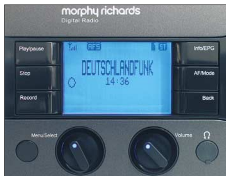
Bild 2: Die wenigen Bedienelemente liegen rund ums kontrastreiche Display. Weitere Einstellungen laufen übers Menü, was die Bedienung für sehbehinderte oder blinde Radiohörer erschwert.
