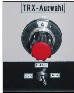
Bild 7: Als Bedienelement prangt ein Drehknopf auf der Frontplatte der Steuereinheit. Der Kippschalter darunter ist nur zum Einschalten des optionalen Filters notwendig.
