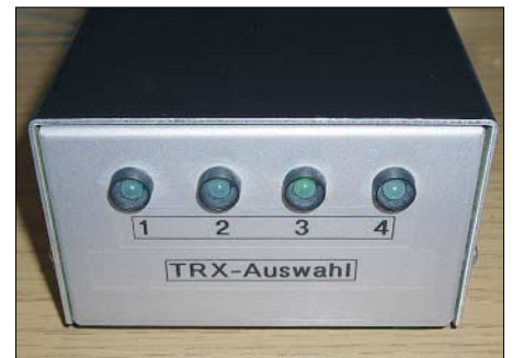
Bild 5: Frontansicht der Relaisbox; die leuchtende LED kennzeichnet den durchgeschalteten Transceiver.
