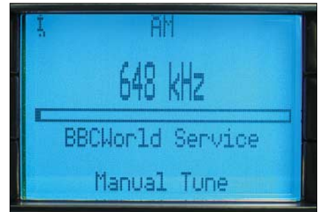
Bild 11: Auch eine manuelle Frequenzabstimmung ist möglich, wenn auch wenig komfortabel. Beim Empfang von AM-Stationen mit AMSS-Datenkanal zeigt der Empfänger unter anderem den Stationsnamen.
